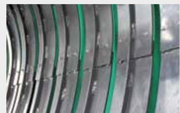
*Placas de fluxo fácil para a pré-câmara*
